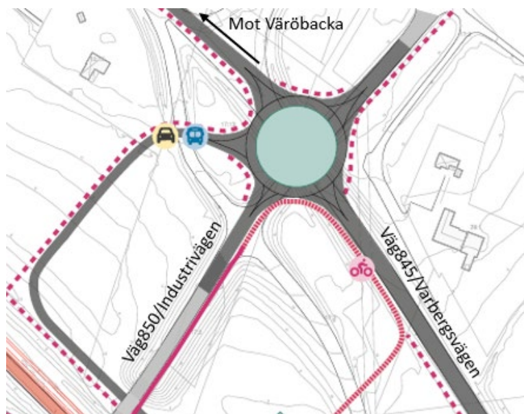
Figur 10. En möjlig lösning för utformning av cirkulationsplats med fem ben där ett av benen går in till stationsområdet norr om vägbron över järnvägen.
