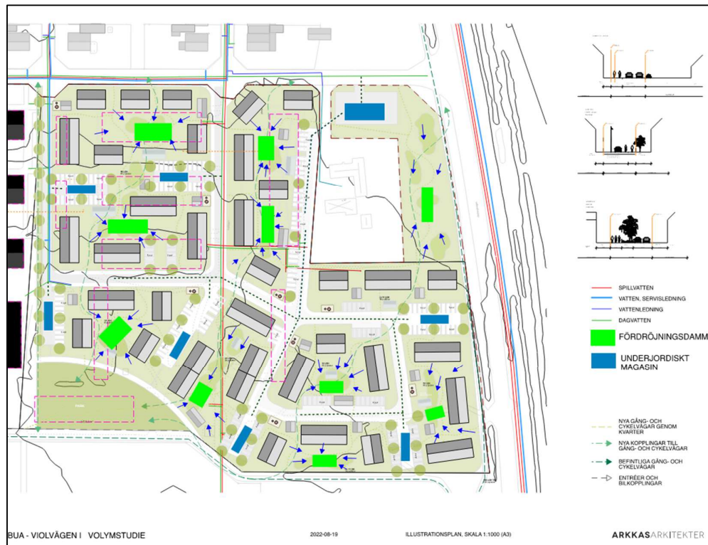
Figur 24. Volym vatten vid ett 100 års regn kan hanteras i torrdammar.
