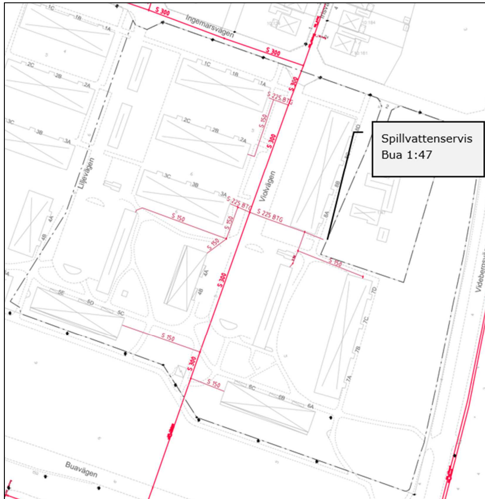
Figur 11. Befintliga spillvattenledningar inom och i anslutning till planområdet.
