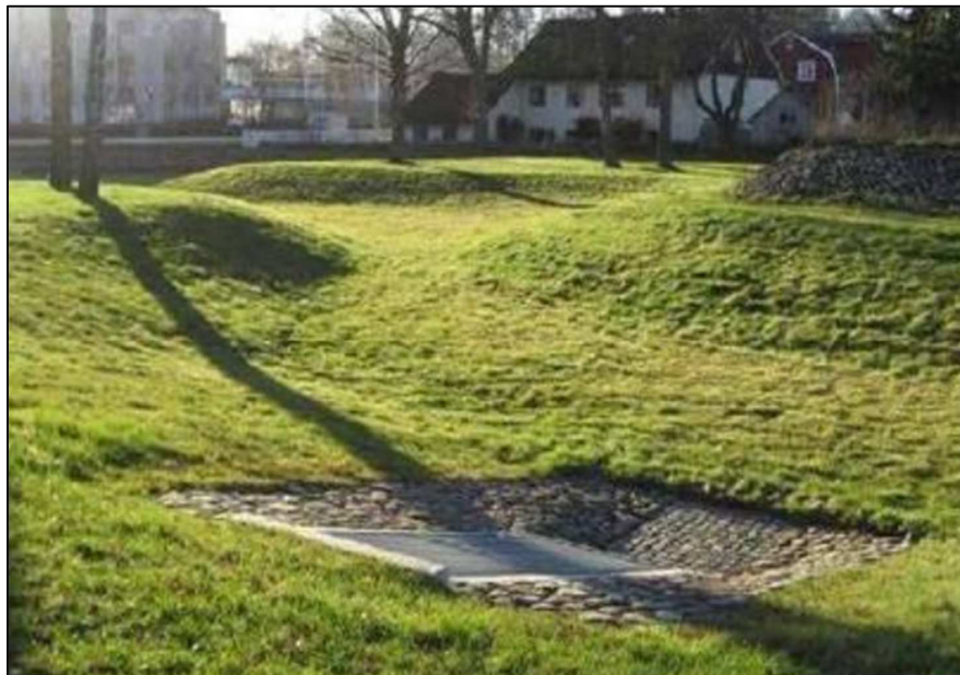
Figur 17. Torr damm som tillfälligt svämmas över (Härryda kommun2011)
