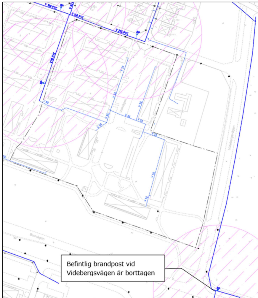
Figur 21 Befintligt täckningsområde för brandposter ( r = 75\text{m} )
