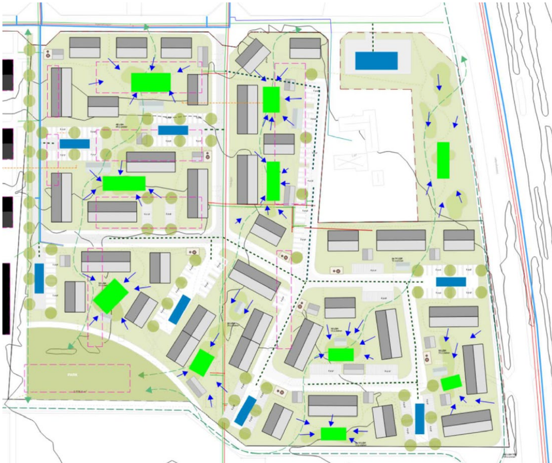
Bild 5. Förslag till dagvattenhantering genom torrdammar (grön symbol) och underjordiska magasin (blå symbol) på kvartersmark. Bild ur VA-utredning.
