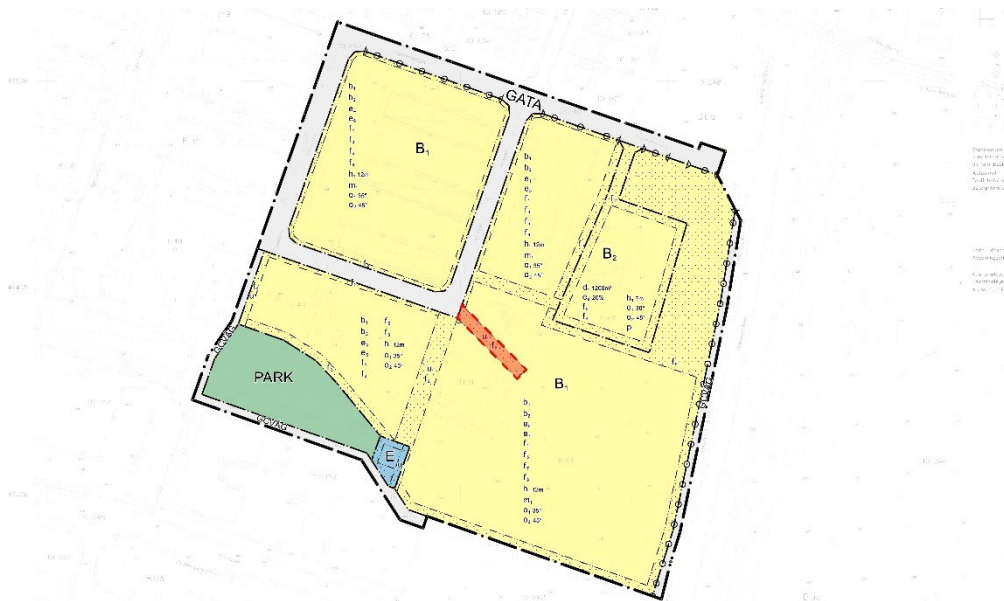
Bild 10. Röd markering illustrerar det markreservat för underjordiska ledningar som beskrivs i text ovan.
