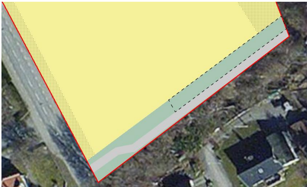
Figur 10. Ytbehov av dike utifrån Vivabs riktlinjer (randvillkor 1), beräknat med en släntlutning på 1:3 och ett djup på 0,3 m.
