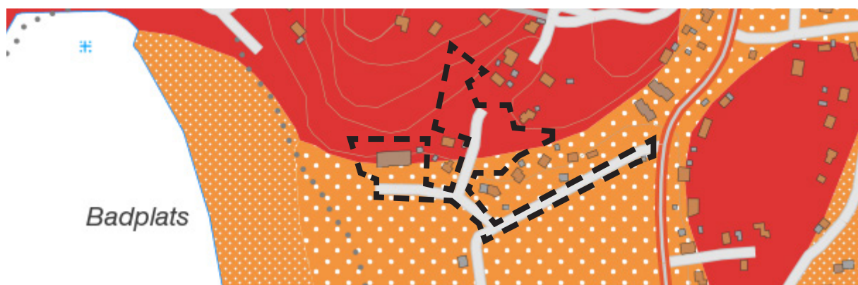
Jordartskarta från SGU (Sveriges geologiska undersökning). Den röda färgen markerar fast berg och den orange utgör svallsediment. Planområdet utgörs av den svarta streckade gränsen.
