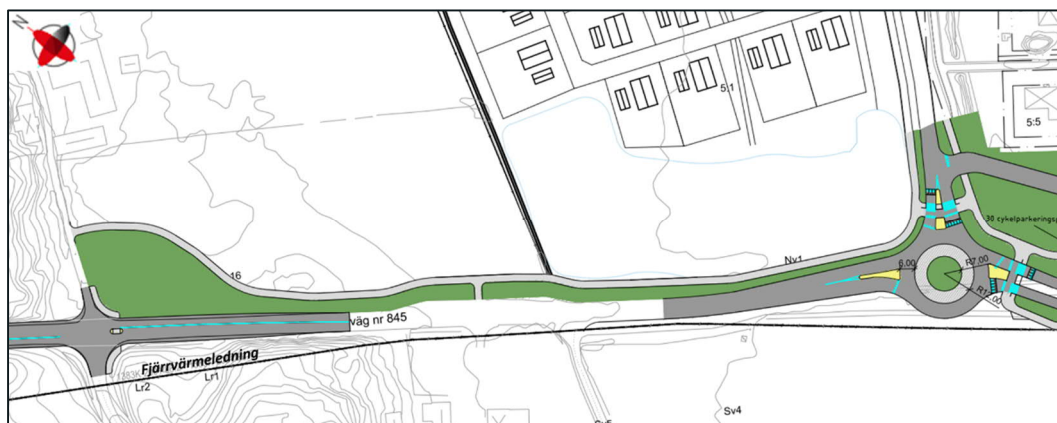
Figur 19. Gång och cykelbana längs väg 845
