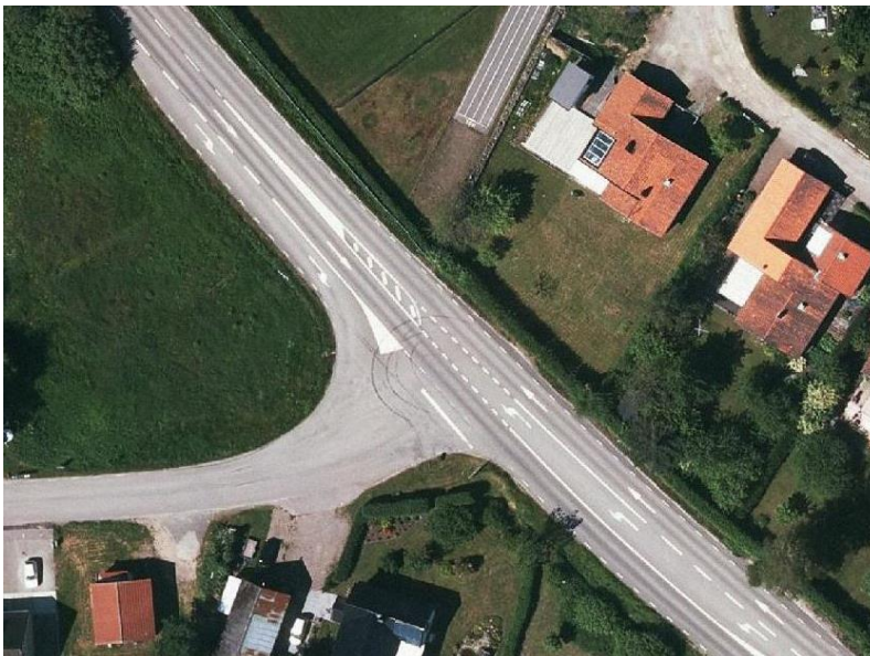
Figur 6. Trönningenäsvägens anslutning till väg 845. Anslutningen är bred, men inga körfält är markerade. Konflikter kan uppstå mellan vänstersvängande fordon söderifrån på väg 845 och fordon som väntar på att svänga vänster från Trönningenäsvägen. Källa: Varbergs kommun
