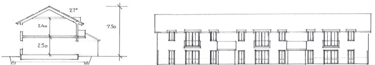
Bild 7. Illustration med sektion respektive fasad mot innergård, för byggnation med bestämmelsen om en högsta nockhöjd på 11,5 meter över angivet nollplan.
